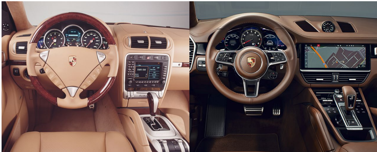
Figure 10 : comparatif de la planche de bord de la Porsche Cayenne 2002 (14 boutons de contrôle du système) à 2018 (tout dans l'écran)
